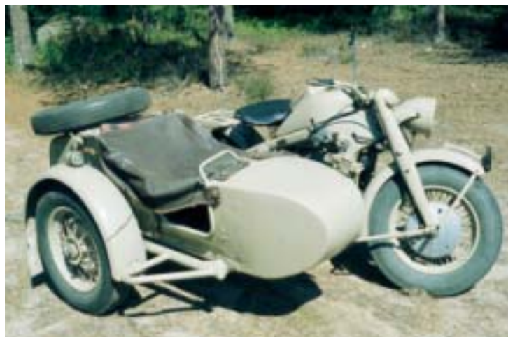
TÄSSÄ yksi niistä pyöristä, joilla poliisi partioi sotien jälkeen; Zundapp KS 750. Myös sivuvaunun pyörä vetää ja peruutusvaihte löytyy. Kuvan ajokki on entisöity ja maalattu Saksan toisen maailmansodan aikaisen Afrikan armeijan väreihin.
